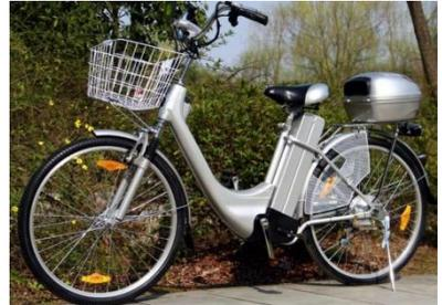
**Pedelec 25:** Bei diesen Modellen endet die elektrische Unterstützung bei 25 km/h. Einige Modelle verfügen über eine zusätzliche Anfahr- und Schiebehilfe bis 6 km/h, die besonders am Berg hilfreich ist.
